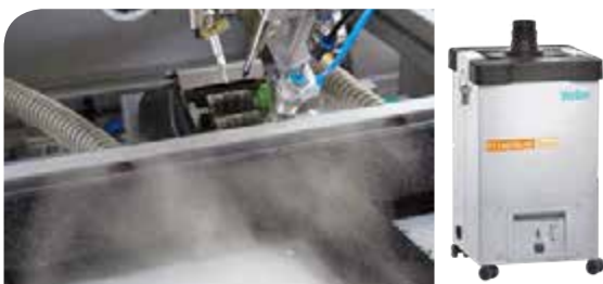
Die integrierte Löt Rauchabsaugung schützt 3-fach gegen Schadstoffe, den Anwender, das Werkstück und die Maschine.
