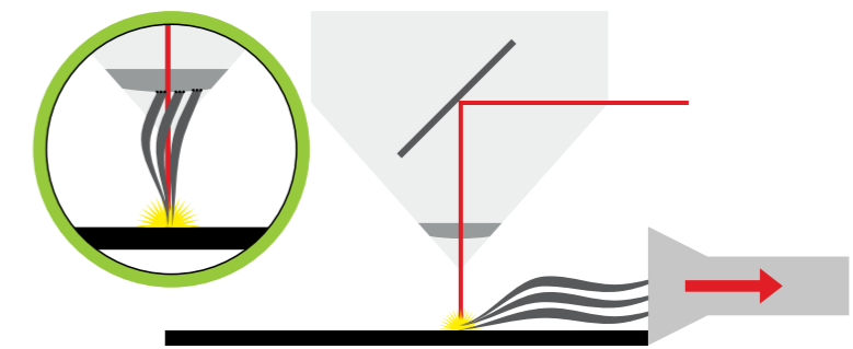
Gezielter Schutz für die Technik: Direktabsaugung an der Quelle
